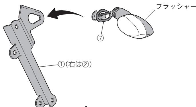
3. フラッシャーを取り付けたブラケットL①・R②をスタンダード車のボルトで車両に取り付け、フラッシャーのカプラを接続します。
