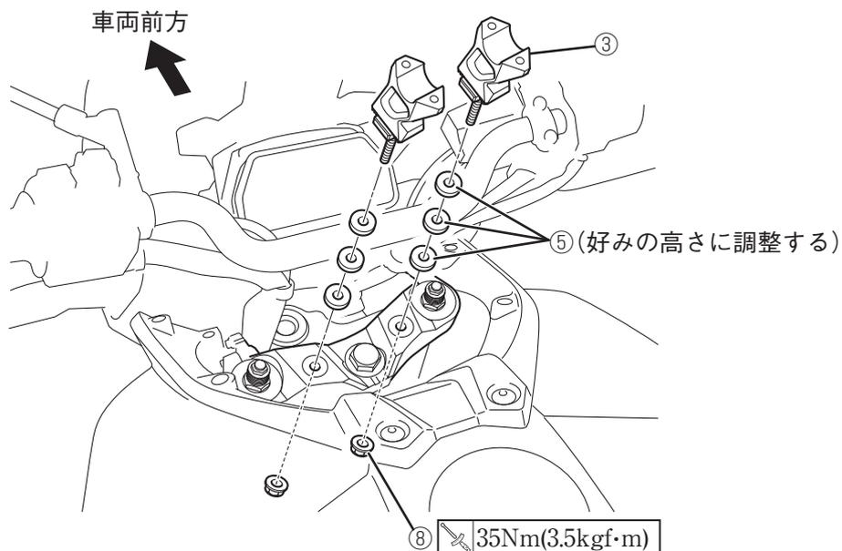
3. ハンドルバーのポンチマークをロアークランプ③の端に合わせ、アップークランプL①・R②ではさみ、ヘキサゴンボルト⑥で固定します。
