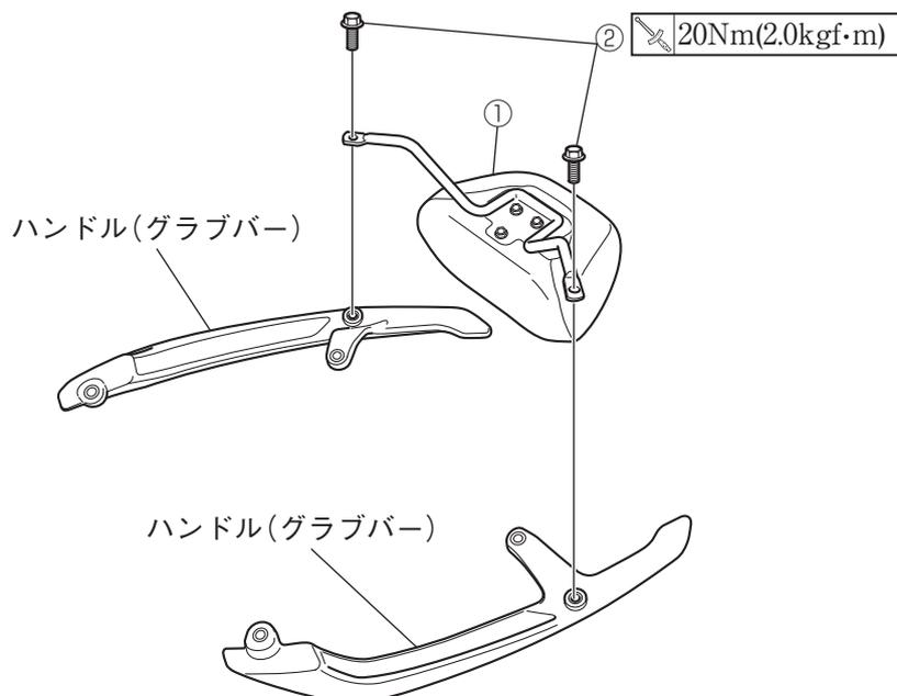
3. ハンドル（グラブバー）をスタンダード車と同じ要領で車両に取り付けた後、フランジボルト②を締め付けます。
