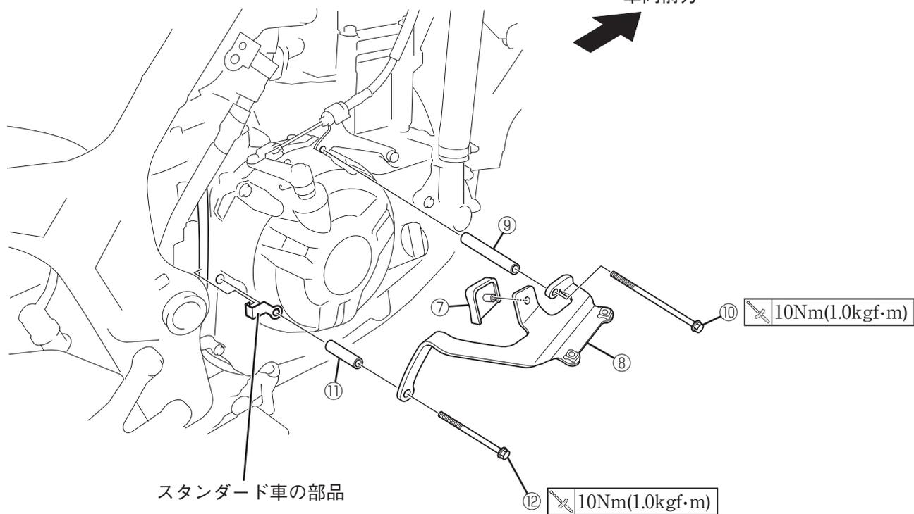
4. 取り外した車両部品を付け直します。🔒
