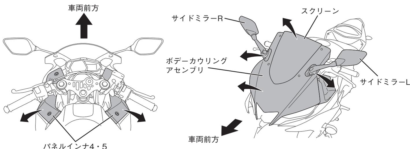
2.スタンダード車のボデーカウリングアセンブリにスクリーン①を取り付けます。スクリュとウェルナットはスタンダード車の部品を再使用してください。
