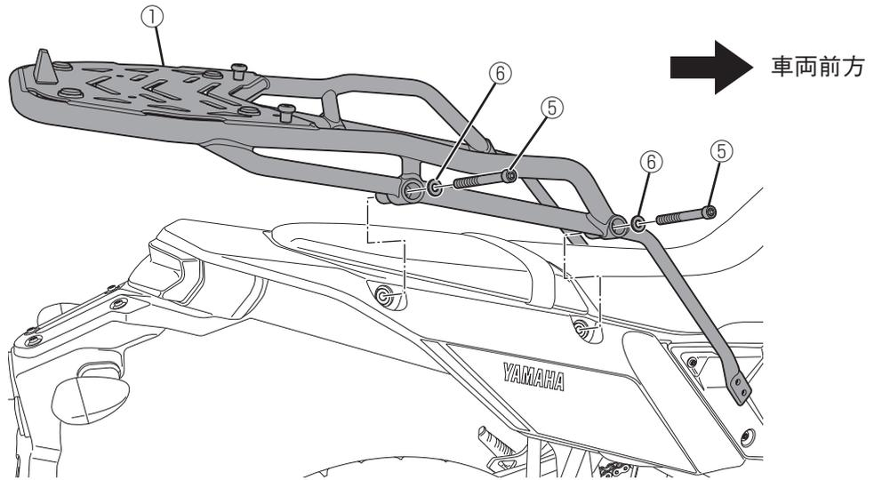
3. キャリア①をボルトヘキサゴンソケット2⑤、ワッシャー⑥、スペーサー⑦で車両の左側に取り付けます。
