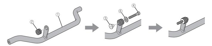
2.車両内部にある孔にスペーサー1⑤を入れ、取付方法1で仮組みした部品のソケットヘッドボルト④を差し込みます。3.ワッシャ1⑥とセルフロックナット⑦で仮止めします。
