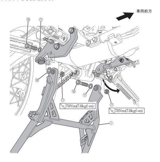
8.メインスタンド①との干渉を防ぐため、サイドスタンドのスプリング取り外し、180度回転させて再度取り付けます。
