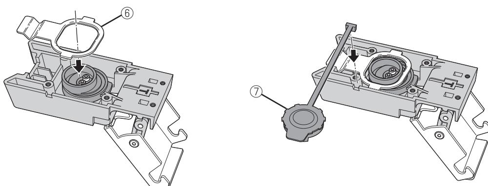
7. キーシリンダー取付部品を元と同じ部品でトップケース①に取り付けます。
