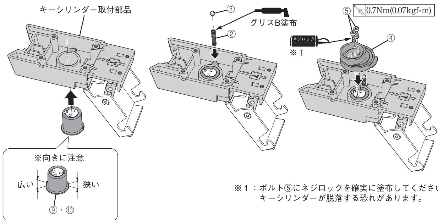
※1：ボルト⑤にネジロックを確実に塗布してください。
