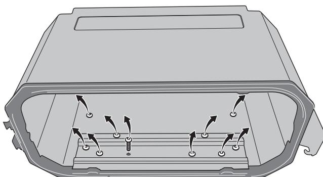
4. ロック部品を取り外し、内側のスプリング部やレバー可動部を清掃します。清掃後はグリスBを塗布してください。
