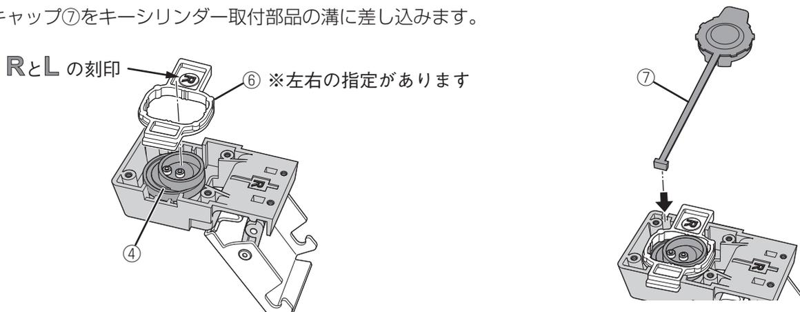
7. キーシリンダー取付部品を元と同じ部品でサイドケースL/R①に取り付けます。
