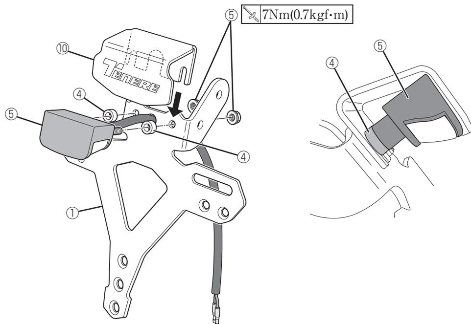
8. 取付方法7で取り付けた部品を下図を参考にスタンダード車のライセンスホルダーベースに取り付けます。
