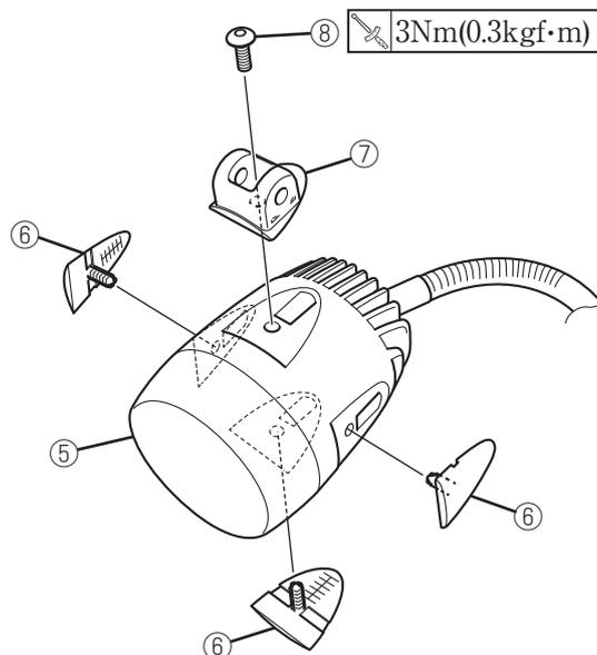
5. フォグランプ⑤をステーL①・R②にボタンヘッドボルト⑧とワッシャ⑨で仮締めします。
