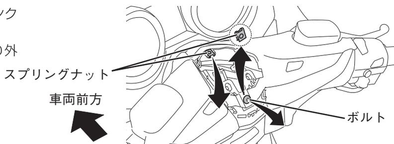
3. スプリングナット⑥を車両に取り付けます。
