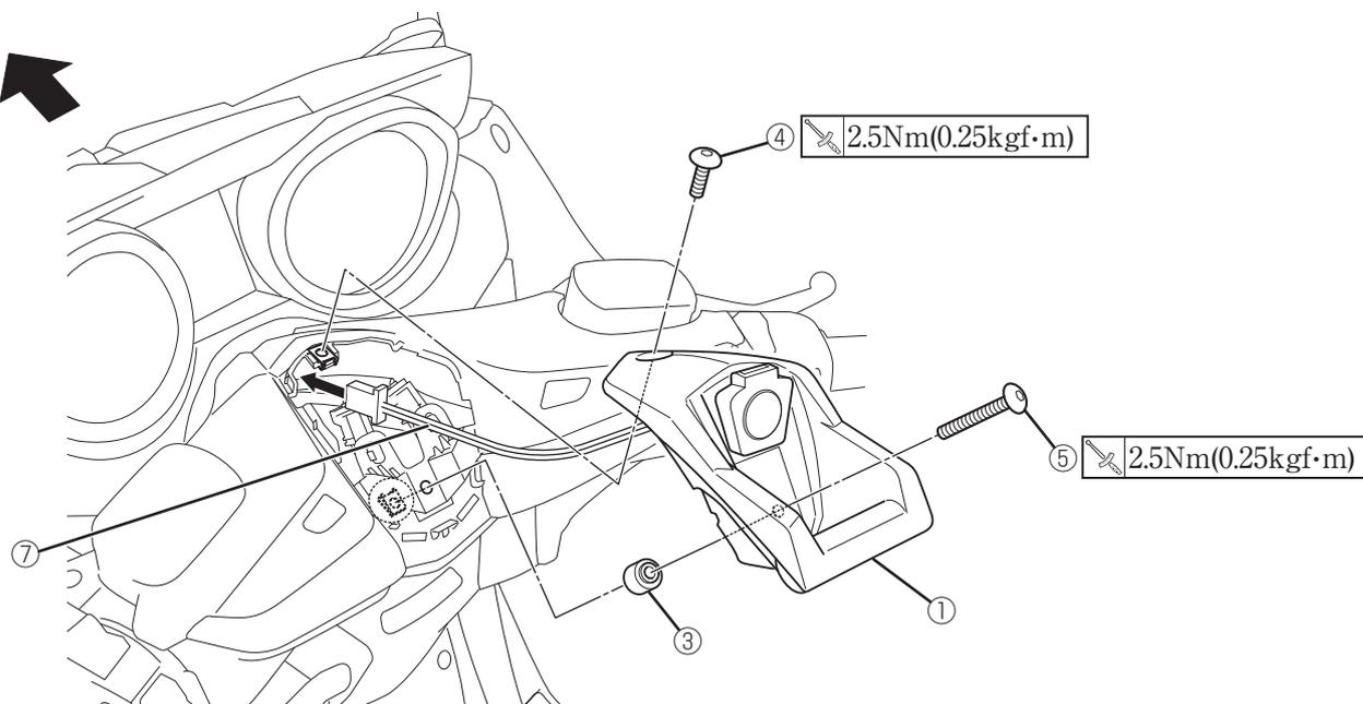
9. ウインドシールド、フロントカバー、バックミラー、ウインドシールドインナーパネル、ボトムサイドカウリング、サイドパネルを取り外します。☐
