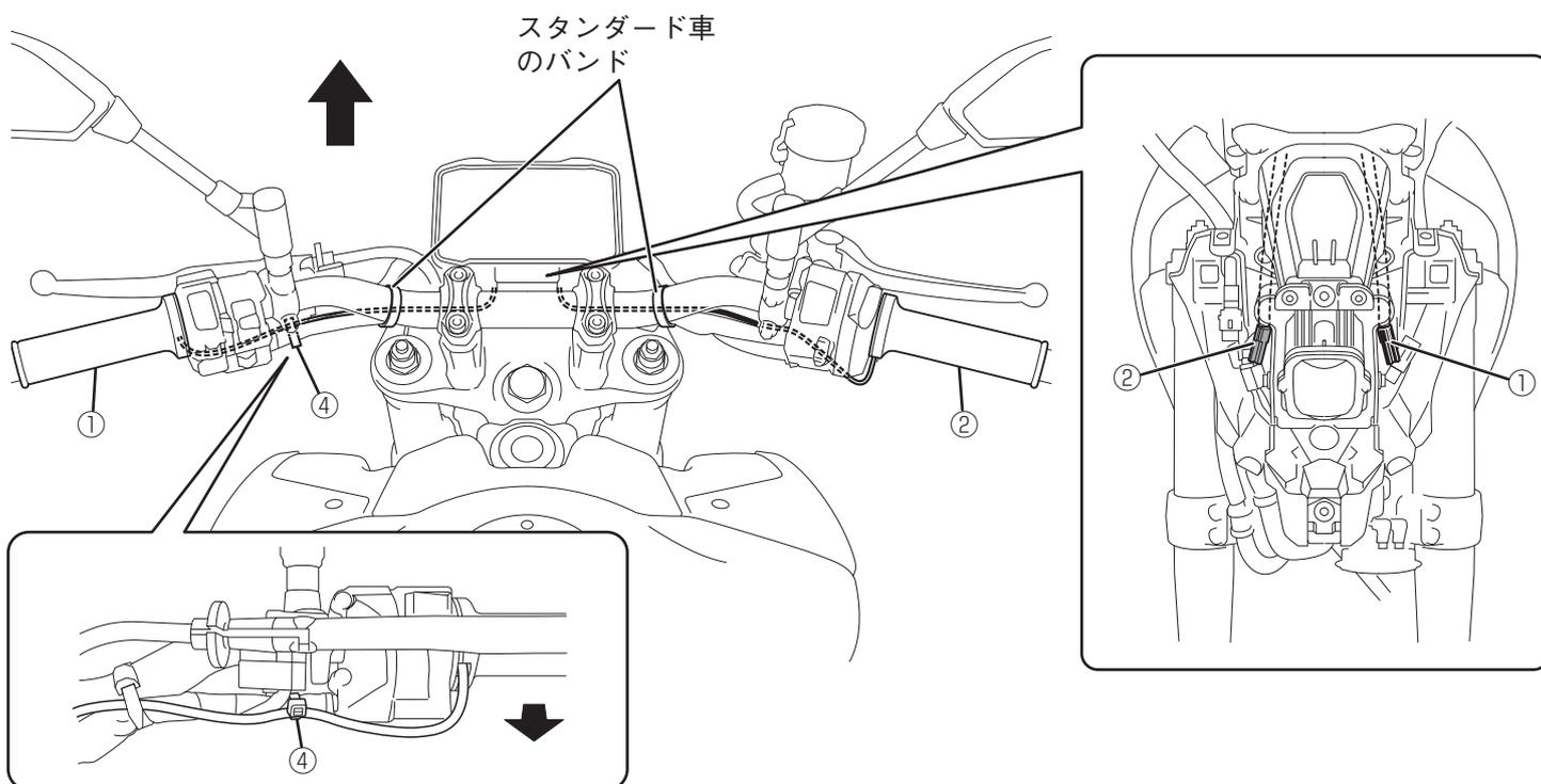
3. グリップウォーマー1①・2②のカプラーを車両の電源カプラーに接続します。
