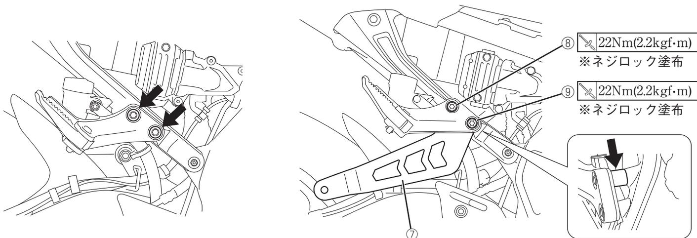
5. 車両の左タンデムステップの取付ボルトをフランジボルト4⑩、フランジボルト5⑪に交換し、取り付けます。※ネジロックを塗布
