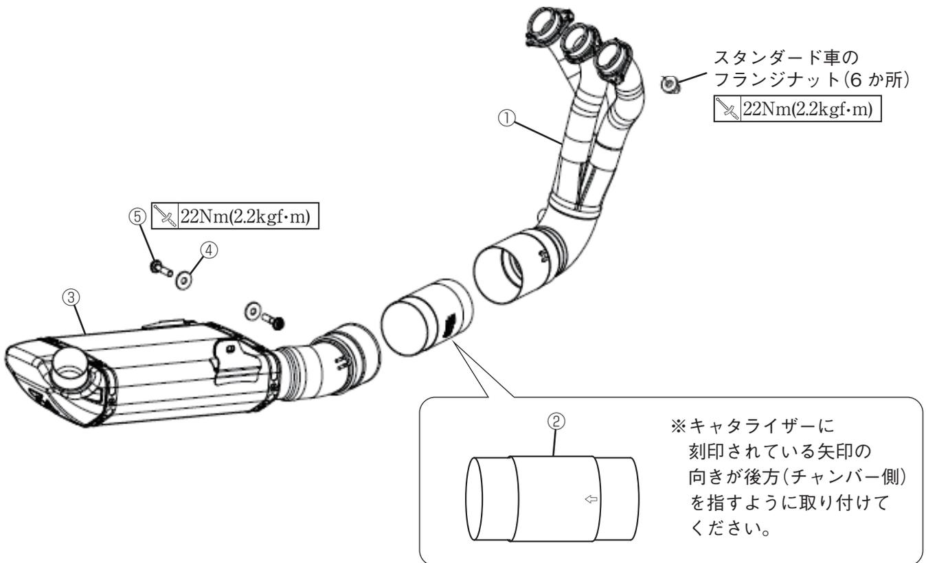
3. スタンダード車のO<sub>2</sub>センサーをエキゾーストパイプに取り付け、チャンバー③との接合部にスプリング⑥を取り付けます。
