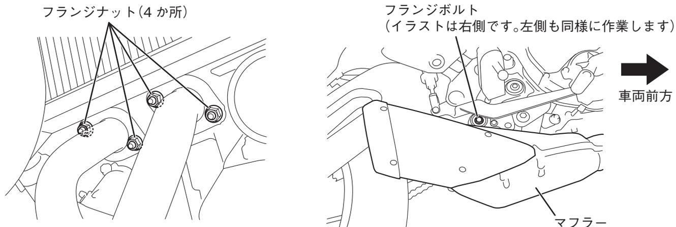
5. フランジボルトを緩め、マフラステーを可能な限り下側にずらしてフランジボルトを締め付けます。
