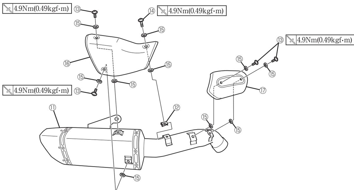
6. サイレンサー⑪のパイプ先端をバンド⑱に通してからチャンバー③後部のパイプ部にスライドさせて差し込み、ブラケット⑩にフランジボルト⑬、ワッシャー⑭、フランジナット⑯を使用して取り付けます。
