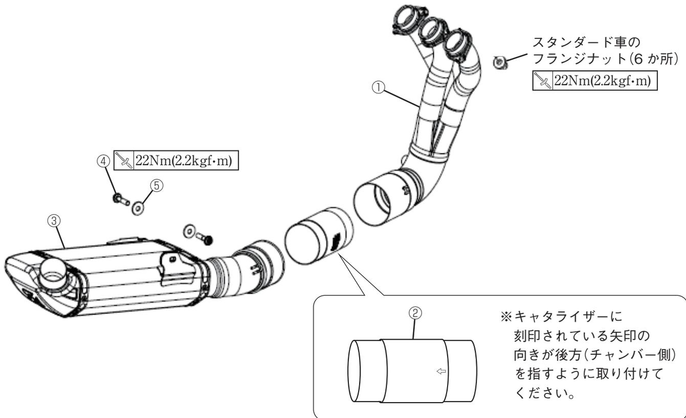
3.スタンダード車のO<sub>2</sub>センサーをエキゾーストパイプ①に取り付け、チャンバー③との接合部にスプリング⑥を取り付けます。
