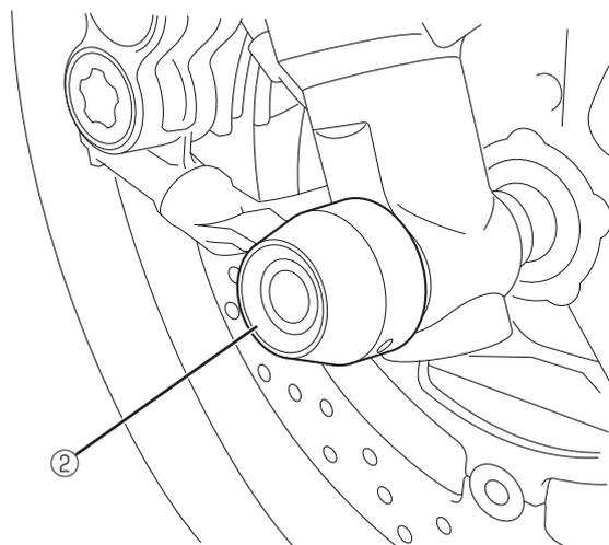
工具は使用せず、突き当たるまで回し込みます。
