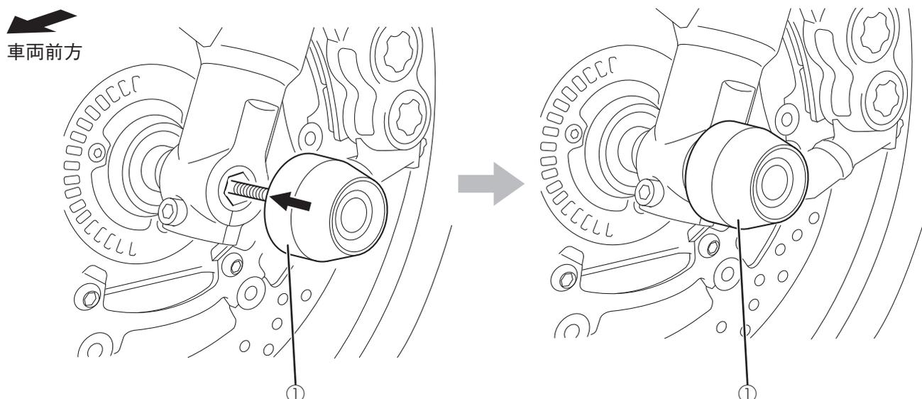
2. プロテクターR②を右側からロッドのネジ部に回し込みつつ、アクスルシャフトに装着します。
