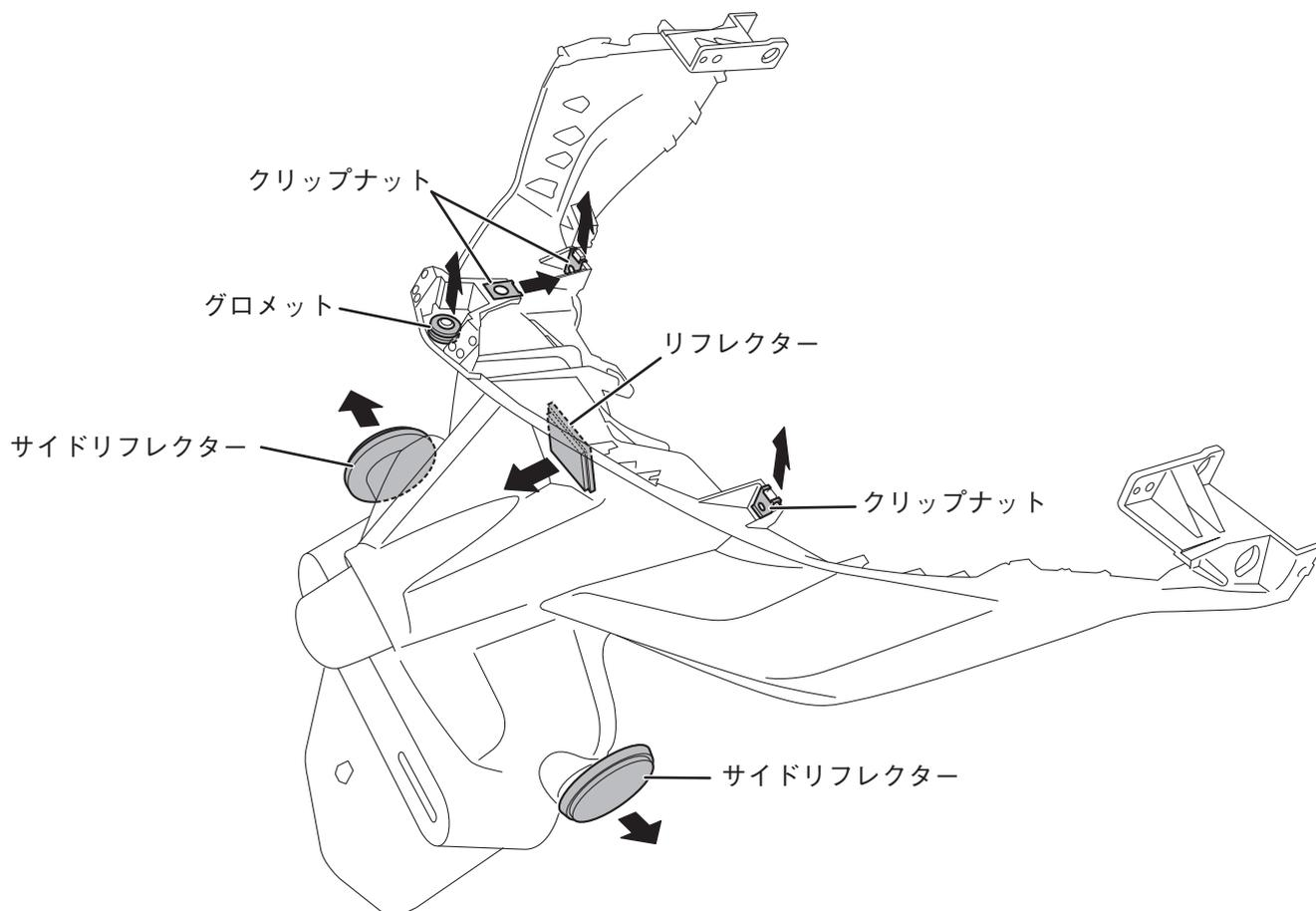
7. ライセンスプレートホルダーカバー⑯に取り外したクリップナット7個とグロメット3個を取り付けます。
