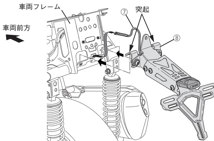
19. ステア2⑨を車両フレームにボタヘッドボルト3⑭、ワッシャー2⑩、ナット2⑬で取り付けます。
