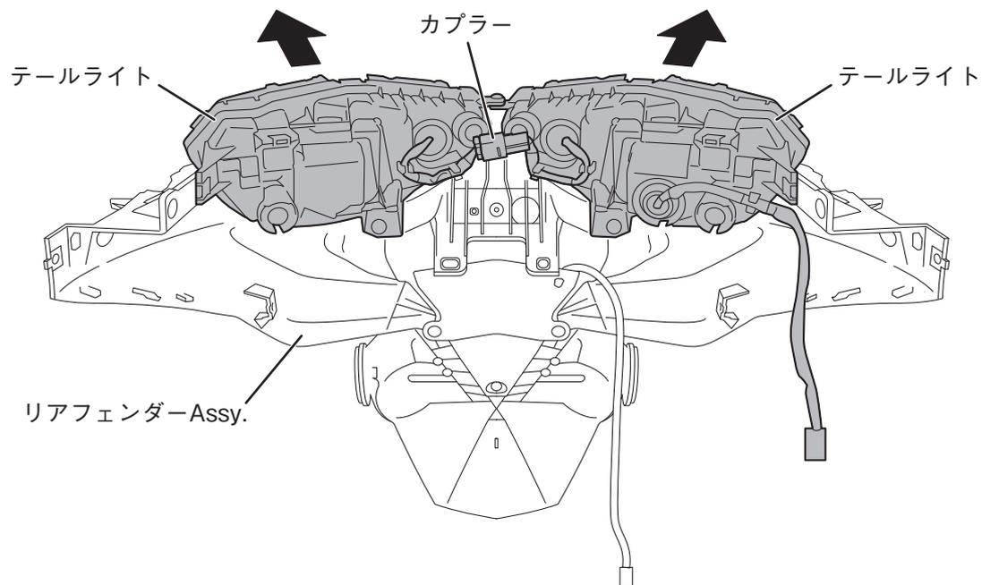
6. リアフェンダー Assy. からクリップナット3個、グロメット、リフレクター、サイドリフレクターを取り外します。
