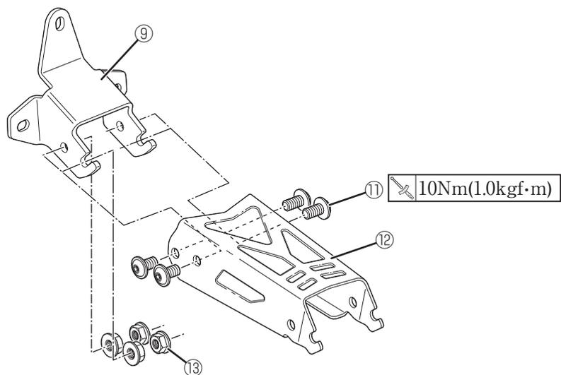
16. センターブラケット②をセンターステー⑫にボタンヘッドボルト2⑪で取り付けます。
