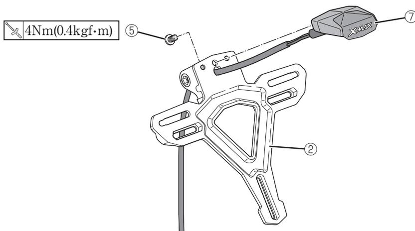
14. ライセンスライト⑦の配線をプレート①の孔に通し、プレート①をセンターブラケット②に取り付けます。
