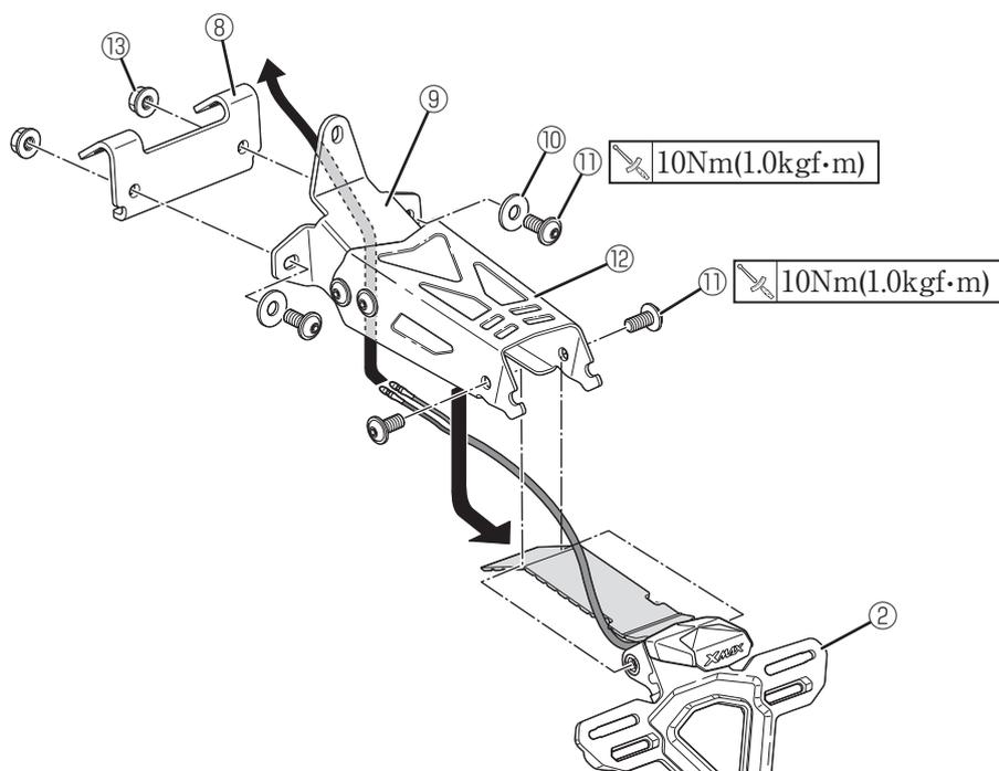
18. ライセンスライト⑦の配線を車両フレームの孔に通し、ステー1⑧の突起を車両フレームに引っ掛けます。
