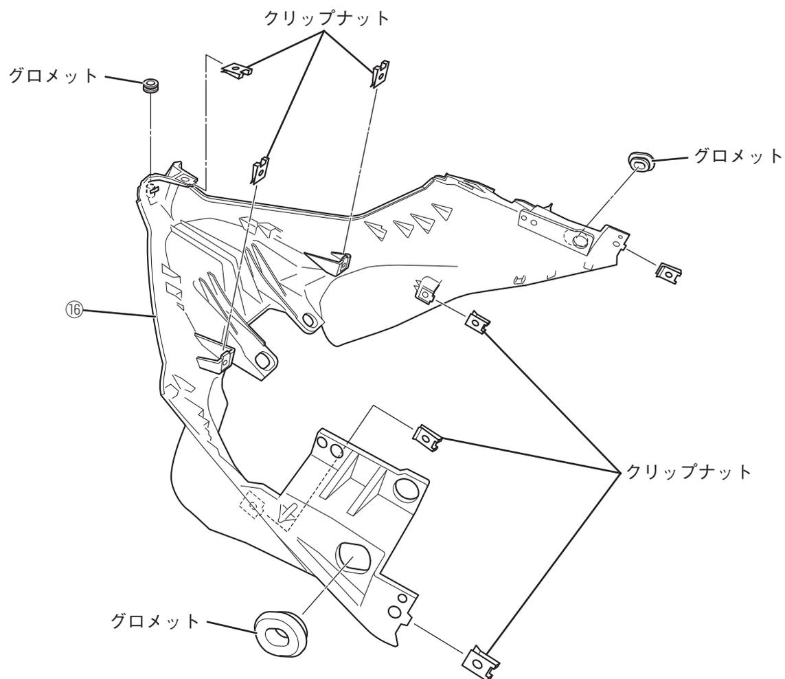
8. ライセンスプレートホルダーカバー⑯に取り外したリフレクターを取り付けます。
