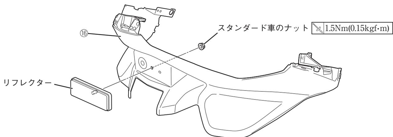
11. プレート①を13の位置で切り込みを入れ、折り曲げて切断します。
