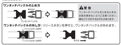
▲ 警告: ●ワンタッチバックルは、<u>必ず最後まで(カチッと音がするまで)きっちり押し込んでください。</u>押し込みが不完全ですと、万一転倒した際にワンタッチバックルが外れてしまい、大変危険です。
