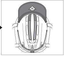
②トップバッド、フロントバッドが装着されていた 箇所に当パーツを取り付けます。このとき取り 付け箇所にしっかり押し付けます。
