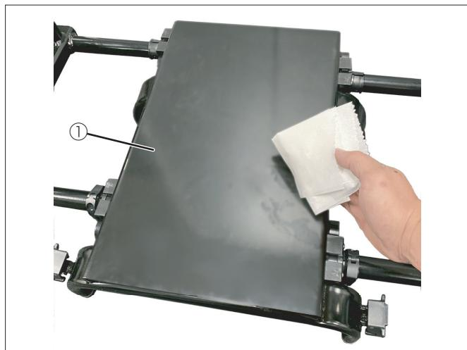
2. マリンマットをマルチユースラック①に合わせます。前後左右の隙間が均等であることを確認します。マットがずれないようにしっかりと固定します。
