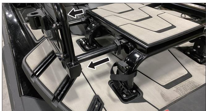
2. クランプは調整可能です。クランプを閉じた状態で側面が動く場合は、クランプを締めてください。クランプハンドルを開き、ハンドルを1回転締めてください。クランプを閉じ、側面が固定されているか確認してください。固定されていない場合は、さらに1回転締めてください。
