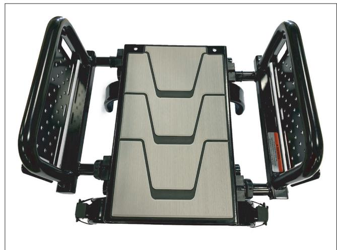
3. マットの位置を動かさずに、マットの前側を持ち上げます。前端の裏紙をはがし、マットの前側の部分を貼り付けます。貼り付けて位置を固定したら、後側を持ち上げて裏紙をはがします。位置合わせを確認し、マットをマルチユースラック①にしっかりと押し付けます。
