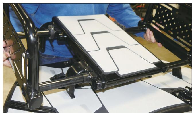
3. マルチユースラック①を斜めにして前支柱をフロントクリートのポケットに差し込みます。マルチユースラック①の後支柱を倒して、後支柱のパッドが後部クリートのポケットに収まっていることを確認します。
