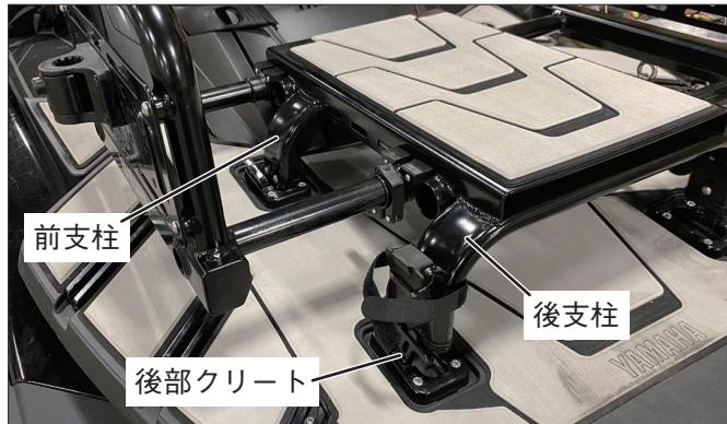
4. 後支柱のラッチを掛けて、マルチユースラック①をクリートに固定します。ラッチフックがクリートにしっかりと固定されていることを確認してください。
