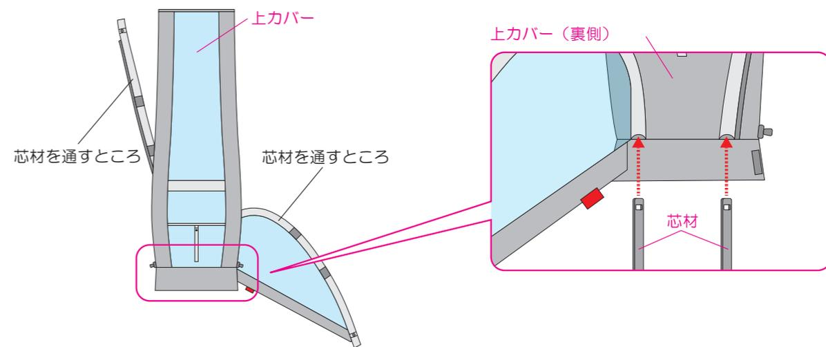
2 上カバーを裏向けにして芯材に軸を取付けます。
