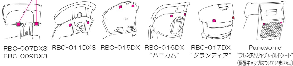
②チャイルドシート背面のアクセサリ穴に軸受けを入れ、軸受けピンを差し込みます。
