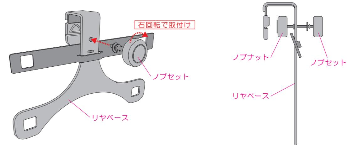
⑥リヤベースと補助金具の穴に軸受けを入れ、軸受けピンを差し込みます。
