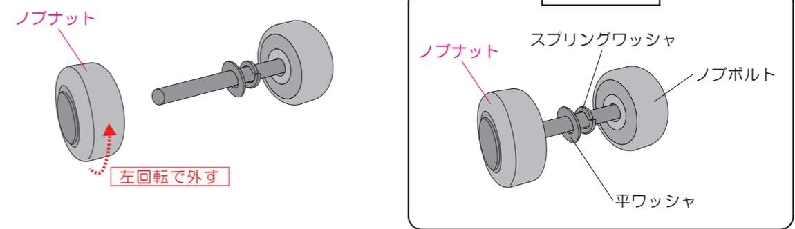
⑤ノブセットからノブナットを外した状態でリヤベースに取付け、再度ノブナットを取付けます。
