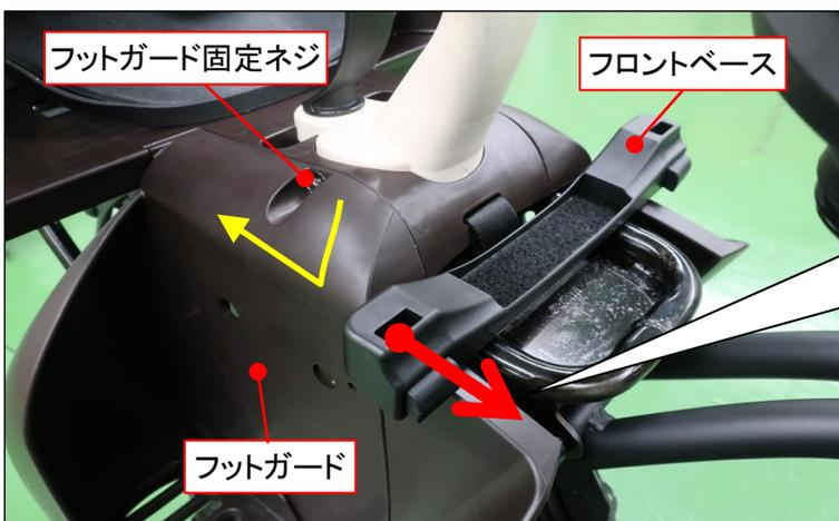
フットガード再組付けは、フロントベース右端を前方に押し出して、フットガードをスライドさせるスペースを作ってから組付けます。(スペースが作れない場合はマジックテープの締め上げ具合を加減してください。)
