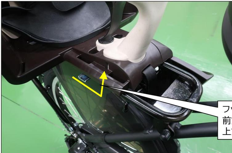
フットガードは固定ネジを外し、前方へ約15mmスライドさせてから上方へ取り外します。
