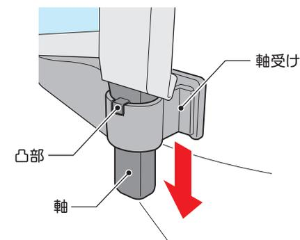
軸の外側の凸部を軸受けの溝にはめます。
