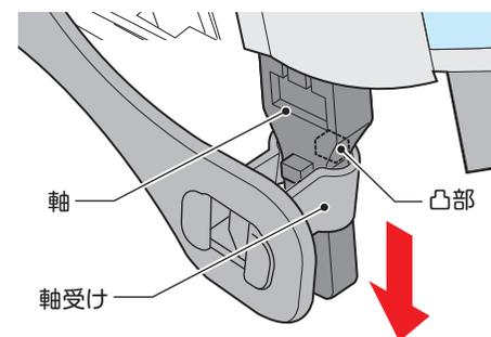
軸の内側の凸部を軸受けの溝にはめます。
