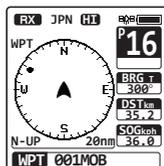
3. DSC 遭難通報を送信するには、トランシーバーの背面にある赤色の DISTRESS カバーを開いて、[DISTRESS] キーを 3 秒以上押し続けます。詳しくは“遭難通報の送信” (30 ページ) を参照してください。このとき DSC 遭難通報の種類は自動的に “MOB” に設定されます。
