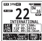
前項の“マルチワッチ機能の設定”の手順2で“TRIPLE”を選択すると、[TRIPLE WATCH]ソフトキーが表示され、押すとトリプルワッチ（3波同時受信）機能が動作します。
