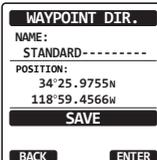
4. [CH ▼]/[CH ▲]/[◀]/[▶] キーを押して、“←” または “→” を選択して変更する文字が選択されるまで、[SELECT] ソフトキーを押して文字を編集します。
