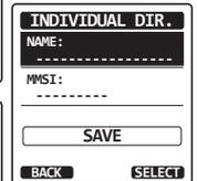
8. [CH ▼]/[CH ▲]キーを押して“MMSI:”を選択して、[SELECT]ソフトキーを押します。
