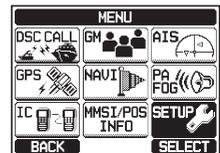
3. **DIAL/ENT**ツマミをまわして“**GPS SETUP**”を選択して、**[SELECT]**ソフトキーを押します。
