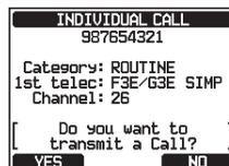
8. 個別コールの確認応答を受信すると、上記の手順6で選択したチャンネルに自動的に変更されて、呼び出し音が鳴ります。
