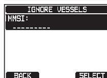
5. **DIAL/ENT**ツマミをまわして数字を選択します。**[SELECT]**ソフトキーを押してカーソルを右に移動します。同じ手順で9桁のMMSI番号をすべて入力します。
