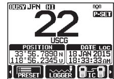
2. **DIAL/ENT** ツマミをまわして、プリセットチャンネルを呼び出します。
