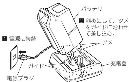
2. バッテリー上部を A 方向へ押し、充電器と確実に接続します
