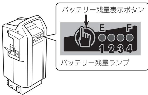
また、PAS のバッテリーは、コンピューターを内蔵しており、バッテリー残量の目安や異常の発生をバッテリー残量ランプでお知らせします。
