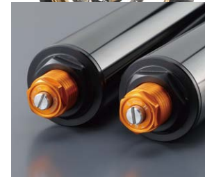
プリロード調整範囲 5mm (64.5N) ~ 18mm (232.2N) 出荷時 15.5mm (200N)
