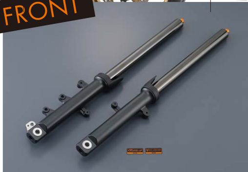
プリロード調整範囲 5mm (64.5N) ~ 18mm (232.2N) 出荷時 15.5mm (200N)
