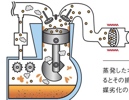
蒸発したオイルが燃焼されるとその排出ガスにより、触媒劣化の原因になります。
