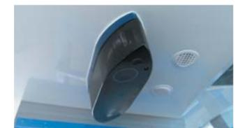
船底にスルーハルで機装された3kWの振動子
