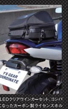
(上) LEDクリアウインカーセット、コンパクトになったカーボン製ライセンスホルダー装着のリア周り。快適ツーリングにとても便利なSTシートバッグ。
