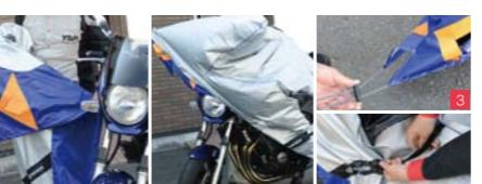
装着手順／1) オレンジ色の三角が前の目印。2) ミラー部からサッとかぶせる。3) 前後の据り式アジャストコードで簡単しっかり固定。4) カバー左右のアジャストベルトを調整して車体にフィットさせたら装着完了。
