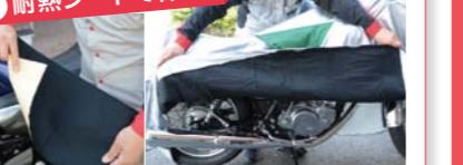
高温となるマフラー・エンジン部分に触れるとバイクカバーが焦げたり融けてしまうことがある。バイクカバー内側の保護したい箇所に耐熱シートを貼っておけば安心だ。SR400には、耐熱シート付きの専用タイプが用意されている。(写真左／耐熱シート。右／バイクカバーFタイプ 耐熱シート付き SR400:18,900円)
