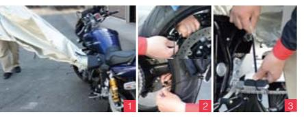
装着手順／1) ポーチを車両(リアインカ)に固定して、クルクル引き出し装着。2) フロント・リアの分割アジャストを固定。3) サイドゴムをステップに装着して完了。
