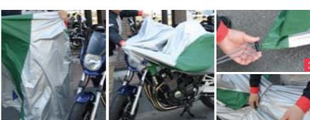
装着手順／1) カバーの緑色が前の目印。2) 上からカバーをバッとかぶせる。3) 前後の据り式アジャストコードで簡単しっかり固定。4) カバー中央のアジャストコードを調整して車体にフィットさせたら装着完了。
