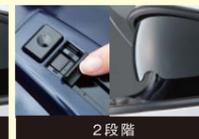
サンバイザーの交換、メンテナンス時にはボタンを押しながら最上部までレバーを動かして脱着位置に。
