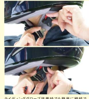
ライディンググローブ装着時でも簡単に締結でき、使いやすいステンレス製のワンタッチバックル式チンストラップ。
