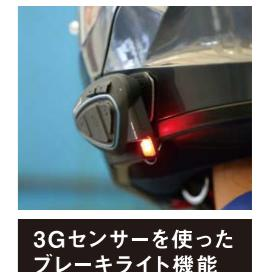
ブレーキライト機能(意匠登録申請中)は、ホルダーハンドル後端に赤色ライトを装備。インターラム内蔵の3Gセンサーが急減速を検知すると点滅。自分自身の急減速を後方の車両に知らせる安全装置である。
