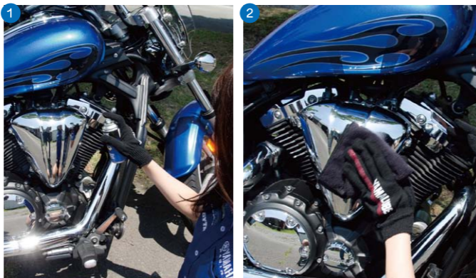
カラカラと音を立てるまで缶をよく振る。 1 約20cm離して均一にスプレー。2 柔らかいクロスなどで丁寧に拭き取る。カルナバロウ配合で光沢皮膜を形成し耐候性に優れた効果を発揮!メッキマフラーは冷えているときに磨き上げ、耐熱ワックスで仕上げるといい。拭き残しは焦げるので注意しよう。
