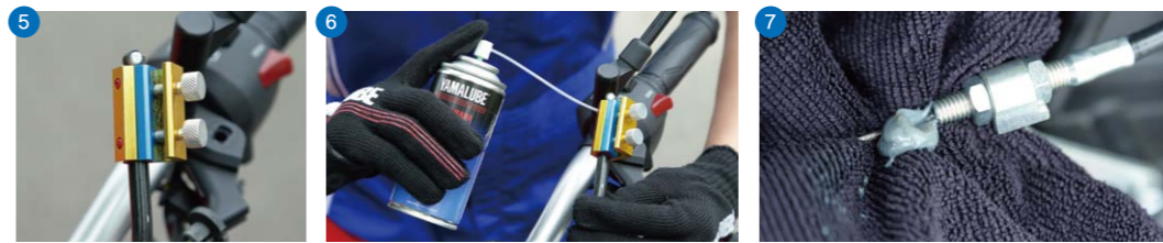
ワイヤーを外す 1 クラッチレバーの固定ナットを外してボルトを抜き、2 アジャスターのストッパーを緩め、3 アジャスターをいっぱいまで締めこんでからレバーホルダーとアジャスターの溝を合わせて4 レバーとワイヤーを外す。
