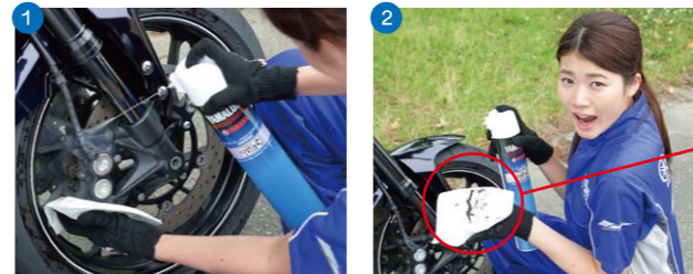
1 ヤマルーブ スーパーブレーキ&オイルクリーナー840をフロントブレーキの汚れた箇所へ直接スプレーし洗浄。エアゾールのガス圧と化学洗浄剤の相乗効果により、すばやく簡単に汚れを落とす。2 ウエスを見てみるとしっかりと汚れが除去されたのがわかる。
