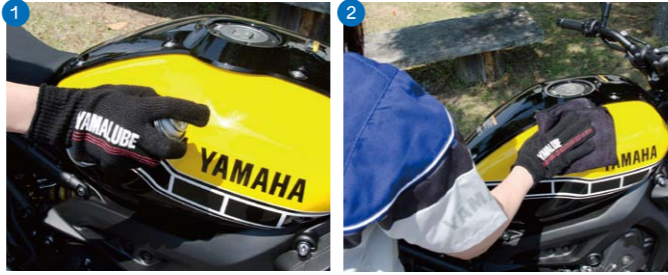
1 塗装面に薄く均一にスプレー。2 専用クロスで縦横に均一に伸ばしながら丁寧に拭きあげる。入り組んだ場所や小さなパーツの場合は、クロスにスプレーしてなじませてから磨こう。
