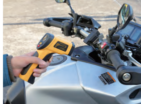
赤外線放射温度計を使い、グリップヒーターの温度を測定。
